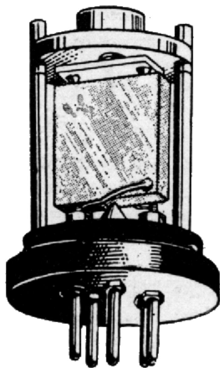
Fig. 23.5. - Cristallo di quarzo sul proprio portacristallo.
