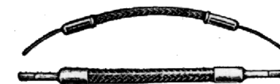
Fig. 4.4. - Esempi di resistenze flessibili, di basso valore.
