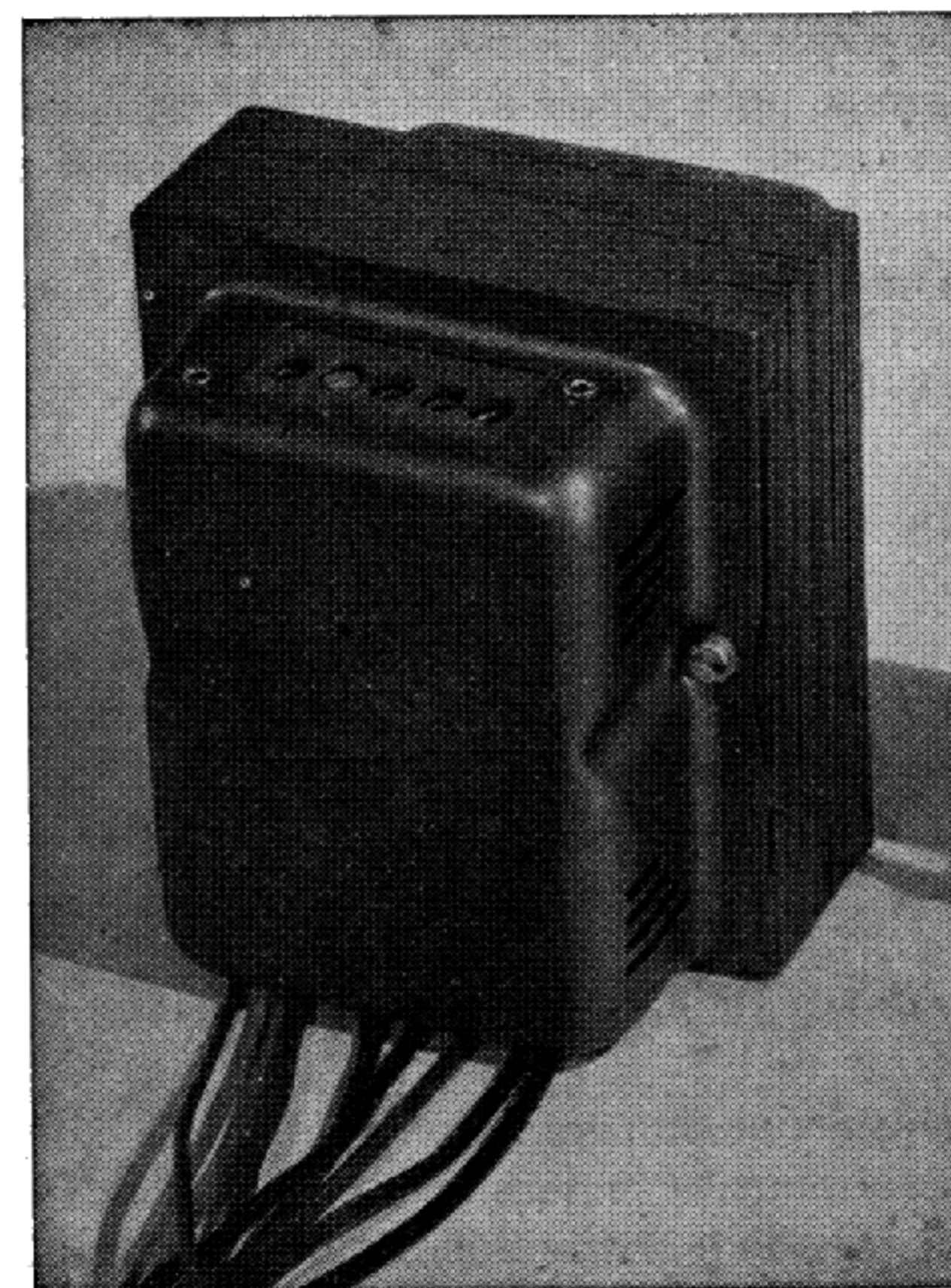
Fig. 16.6. - Trasformatore di alimentazione in custodia con cambio-tensioni.
