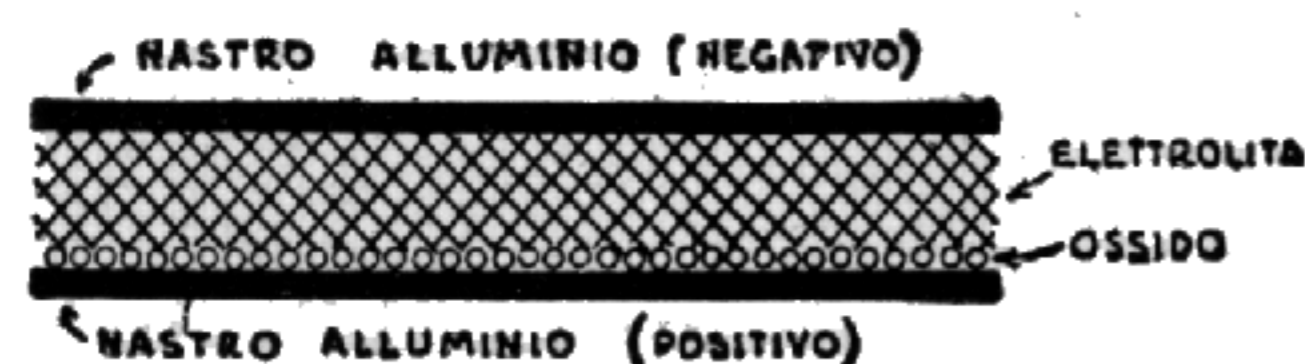
Fig. 5.8. - L'ossido di alluminio è presente sul nastro positivo ed è mantenuto dall'elettrolita.
